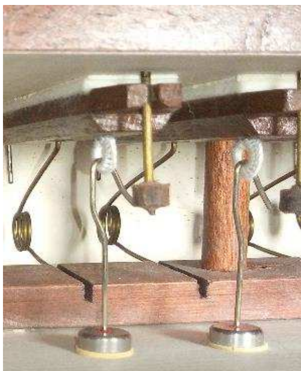
Windlade innen mit neuen Edelstahlpulpeten / gehäkelten Abzugsösen
